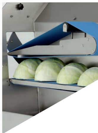
Grâce à une largeur d'amenée pratique, les produits ne nécessitent qu'une coupe grossière au préalable
