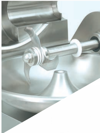
Tête à 3 lames amovibles, en option avec 6 lames
