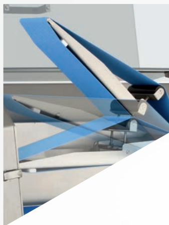
Réglage de la bande convoyeuse supérieure en fonction des produits
