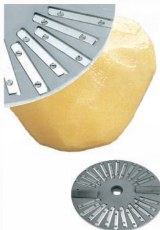
Disque éplucheur garni de lames Surface lisse comme un épluchage manuel. Davantage d'épluchures, rougissement minimal, durée d'épluchage plus courte.
