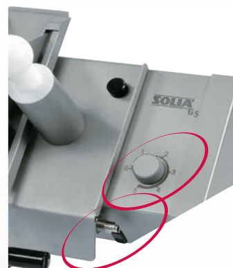
Reglage de la vitesse en continu de 130 à 360 tours min
